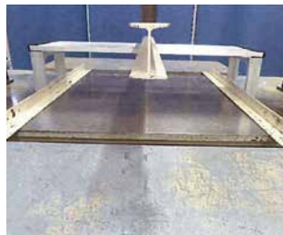
●板書ステップ (P32) / 鉛直荷重試験 最大荷重 978kgf
