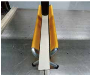
●ベンチ (P32) / 鉛直荷重試験 最大荷重 240kgf
